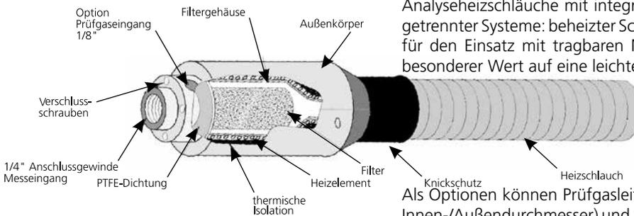
Als Optionen können Prüfgasleitungen (PTFE Innenrohre mit 2/3 mm oder 4/6 mm Innen-/Außendurchmesser) und Steuerleitungen in dieses System eingebaut werden. Das Filtergehäuse besteht aus V4A (1.4571) Stahl. Ausführungen in Hasteloy oder mit PTFE-Beschichtung sind ebenfalls möglich. Die Heizschläuche können problemlos an verschiedene HORST-Temperaturregler angeschlossen werden.
