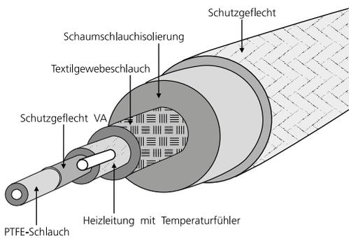
Das mediumführende PTFE-Innenrohr ist mit einem Schutzgeflecht ummantelt. Darauf wird in enger Steigung die Heizleitung mit eigenem Schutzgeflecht nach VDE-Richtlinien aufgebracht. Der Aufbau ist feuchtigkeitsgeschützt.
